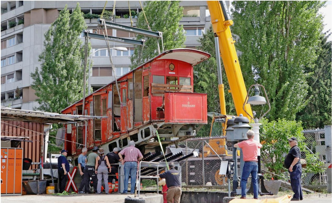
Aufsetzen auf die nachgebildete Gleisanordnung mit drei Schienen und zwei Zahnstangen entsprechend...
